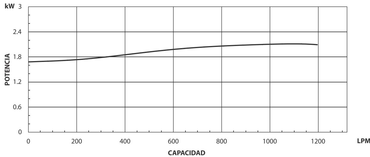
Prueba realizada con agua, gravedad específica 1.0 @ 20 °C (68 °F); otros líquidos pueden variar el rendimiento.
