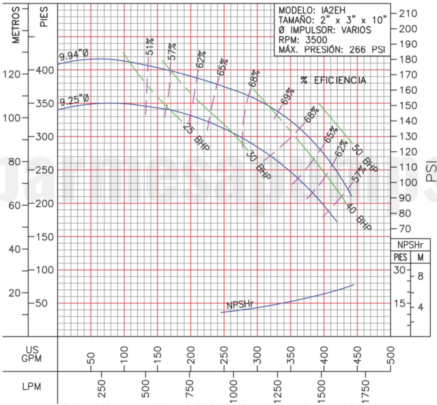
Prueba realizada en agua, gravedad específica 1.0 @ 20°C (68°F), otros líquidos pueden variar el rendimiento
