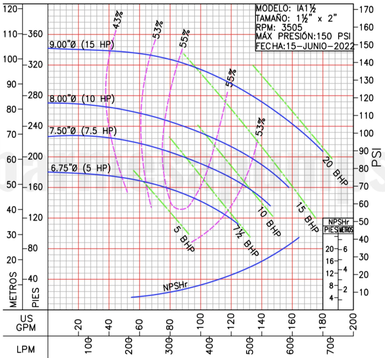
Prueba realizada en agua, gravedad específica 1.0 @ 20°C (68°F), otros líquidos pueden variar el rendimiento
