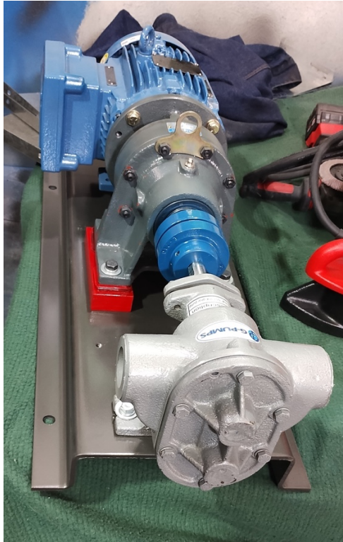
Bomba KG4-SS acoplada mediante cople flexible a motorreductor electrico horizontal sobre base metálica troquelado tipo canal sombrero con cubre cople.
